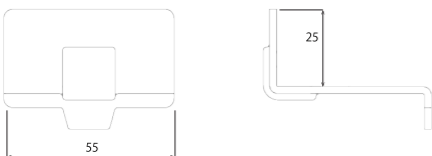
例：リップ溝形鋼 + ステンレスHCクランプ + SLC-50
